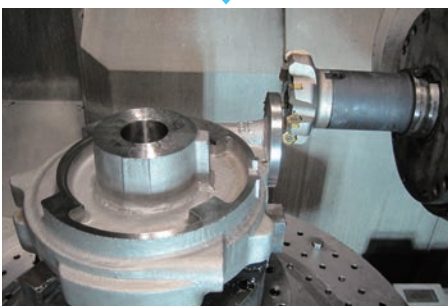
(ケーシング加工中)
